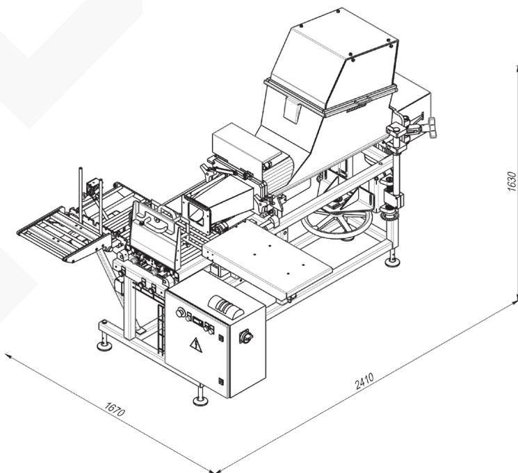
La máquina **ORG** rellenadora de mantequilla a granel es semiautomática y está diseñada para rellenar cajas prefabricadas (bolsa en caja).
