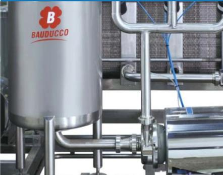
Para calefacción de producto en tanques con camisas de recirculación, con control automático. Para aplicaciones específicas (por ejemplo: mix de helados).
