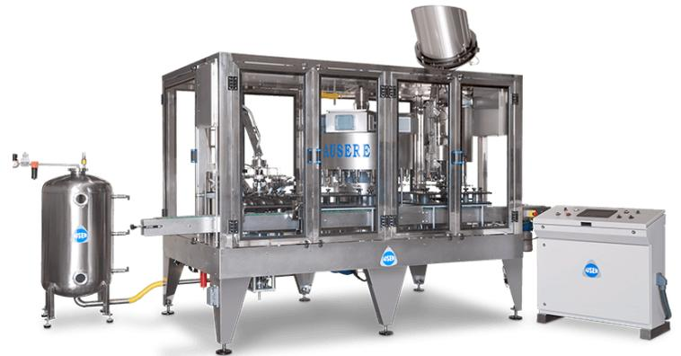
Así mismo y como se muestra en la fotografía, cabe la posibilidad de incluir una torreta de soplado/enjuagado formando un **TRIBLOC** con el llenado y el capsulado. Esta torreta es una máquina rotativa de funcionamiento mecánico equipada con el número adecuado de cabezales para asegurar un tiempo de tratamiento óptimo ajustado a sus necesidades. Ambos grupos poseen su sistema de regulación de altura motorizada.
