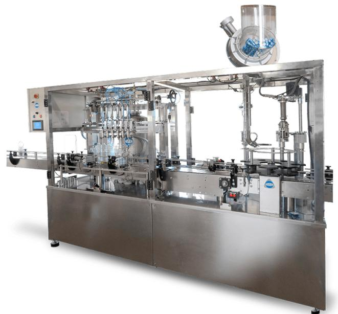
Para el cierre de los envases, lleva acoplado un capsulador automático para tapones de plástico con cierre a presión o rosca y tapones metálicos (pilfer-proof) con cierre a rosca, formando un MONOBLOC con la llenadora, compuesto de tolva de acumulación de tapones, distribuidor – orientador de tapones, rampa de bajada y disco de cierre a presión o un cabezal de cierre a rosca.
