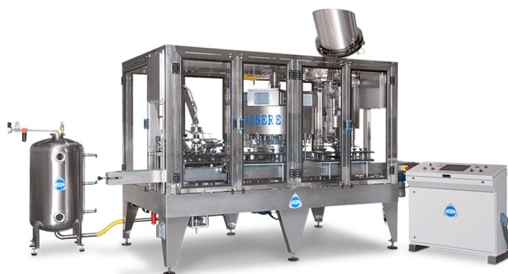
Da mesma forma, e como mostra a fotografia, é possível incluir uma torre de sopro/lavagem, formando um **TRIBLOC** com enchimento e tampamento. Esta torre é uma máquina rotativa operada mecanicamente e equipada com o número adequado de cabeças para garantir um tempo de tratamento ideal ajustado às suas necessidades. Ambos os grupos possuem sistema próprio de regulação de altura motorizada.
