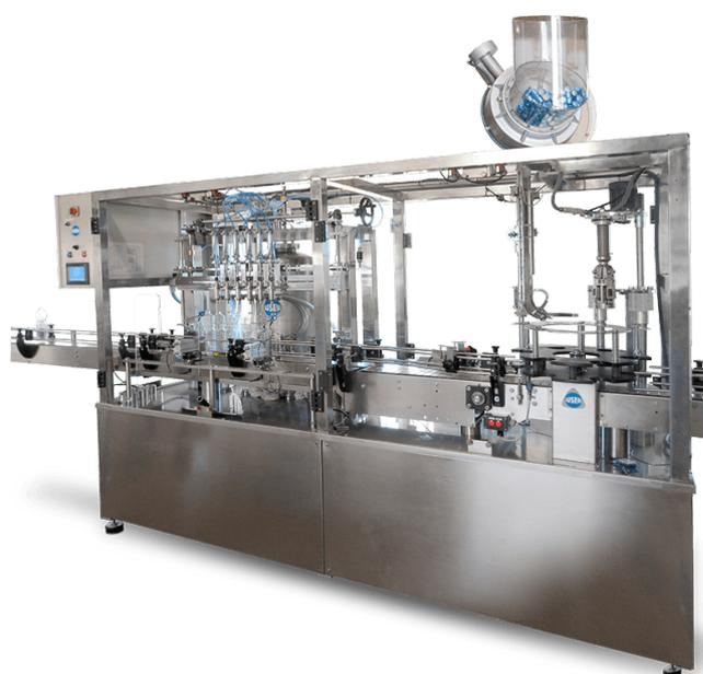
Para fechamento dos recipientes, possui tampa automática para tampas plásticas com fechamento por pressão ou parafuso e tampas metálicas (à prova de furto) com fechamento por parafuso, formando um MONOBLOCO com o enchedor, composto por moega de acumulação de tampas, distribuidor – guia de tampas, descida disco de fechamento por rampa e pressão ou cabeça de fechamento por parafuso.
