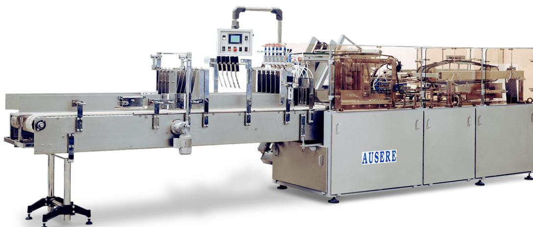
Máquina rotativa e de acionamento mecânico para posicionamento de embalagens plásticas (PET, PVC ou POLIPROPILENO) e sua colocação automática em uma esteira geral que as leva até a envasadora.
