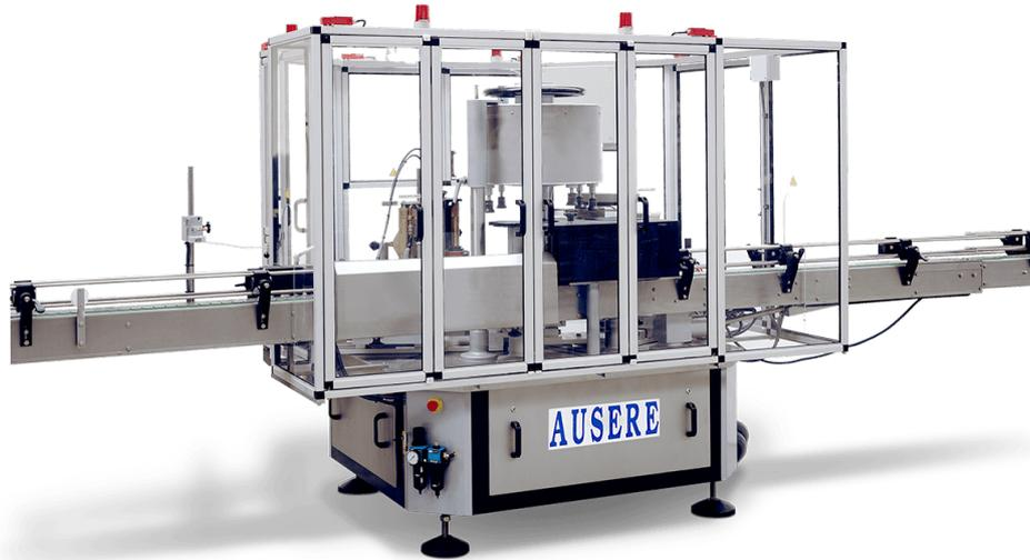
Máquina de funcionamiento rotativo o lineal y automático para el etiquetado de cualquier tipo de envase con etiquetas parciales y envoltentes.
